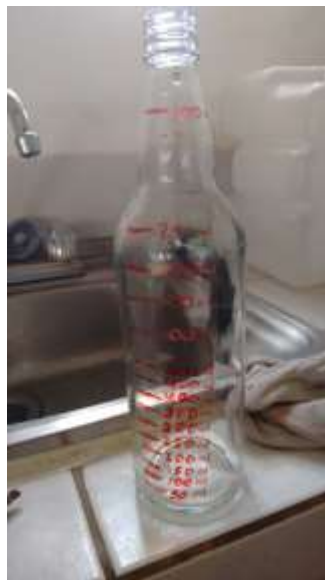
Figura No. 2. Marcas de escala de agua cada 50 ml en botellas de vidrio (Trabajo de campo, 2015)
