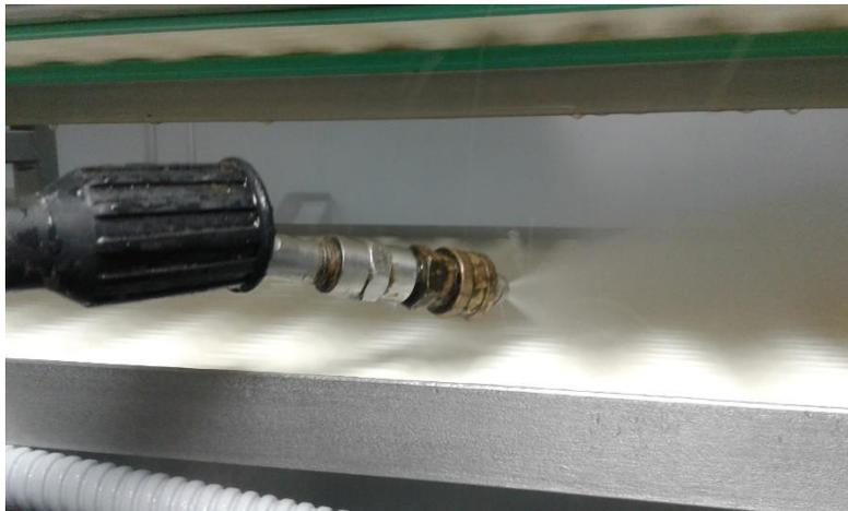
**Figura No. 5.** Limpieza con vapor húmedo del interior de banda de transporte (Trabajo de campo, 2016)
