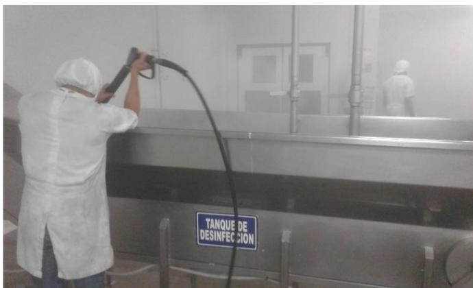
**Figura No. 8.** Limpieza con vapor húmedo del tanque de desinfección
