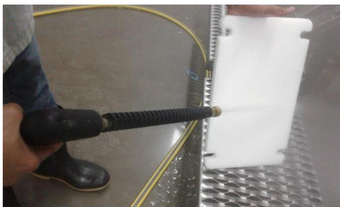
**Figura No. 11.** Limpieza con vapor húmedo de tablas de fileteo
