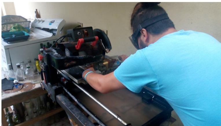
Figura 8: Sierra para el corte de las botellas de vidrio.
