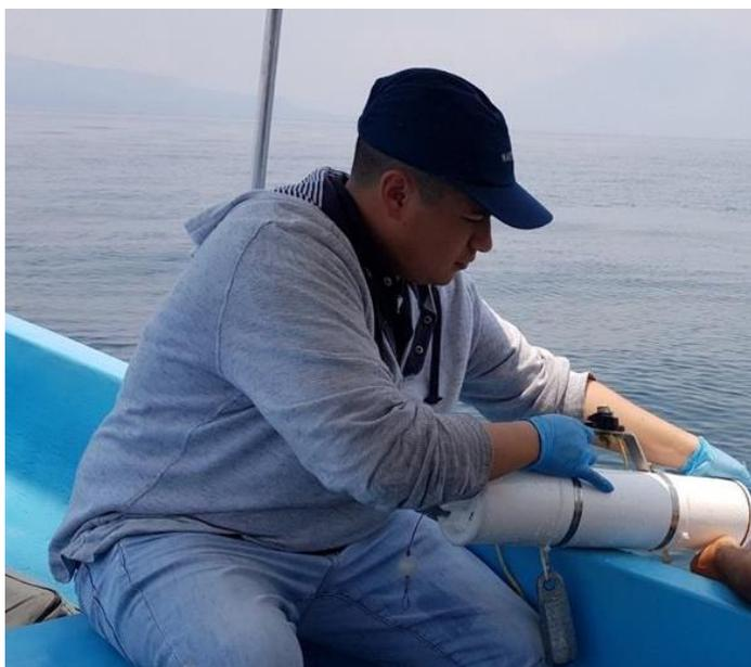
*Figura 4.* Utilización de la botella Van Dorn para la toma de muestras
