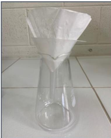
*Figura 15.* Filtro, embudo y cristalería para el proceso de filtración
