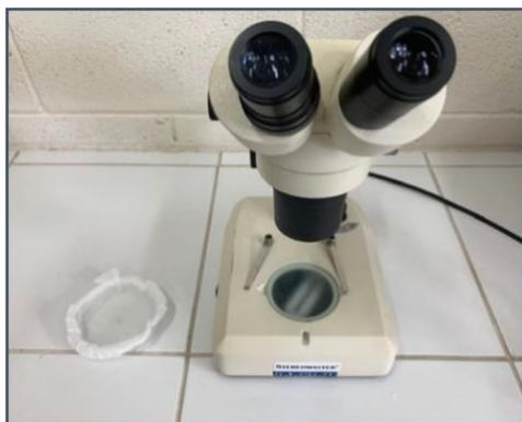
*Figura 17.* Filtro utilizado como método de control para la contaminación por microfibras y estereoscopio para cuantificar los microplásticos
