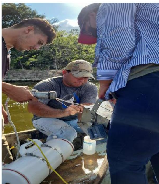
Figura 5. Muestreo de macroinvertebrado con draga tipo ponar
