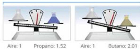
**Figura 9. Densidad relativa de los gases que componen el LPG con el aire**
