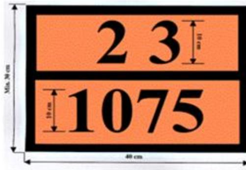
**Figura 6. Placas de seguridad para el transporte de Gas Licuado del Petróleo**
