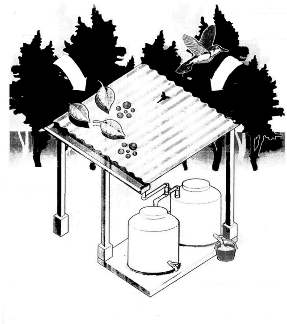
Figura 9. Limpieza del sistema de abastecimiento de agua por medio de aljibes
