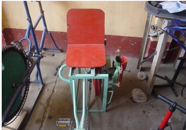
IMAGEN No. 39. Bicidesgranadora. Se observa la adaptación para desgranar maíz.
