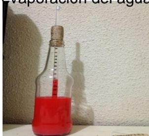
Quinto: Colocar la botella en una base en forma de L, elaborada con tablas de madera u otro material que sirva de soporte, en la parte vertical se coloca una imagen donde indica que si el agua que está dentro de la botella sube es porque podría ser un clima soleado y si el agua se ubica en la parte más baja indica que el clima podría estar nublado o con lloviznas.
