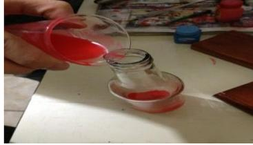
Cuarto: Se introduce el tubo con el tapón. Se absorbe el agua con mucho cuidado, hasta que alcance la mitad superior del tubo. Sin sacarlo del agua, se comprueba que el tubo no llegue a tocar el fondo de la botella. Hecho todo esto, y siempre sin sacar el tubo, encaje el tapón de corcho en el cuello de la botella. Para que quede herméticamente cerrado. Por último, se tapa el extremo superior del tubo con algodón para que la evaporación del agua sea la menor posible.
