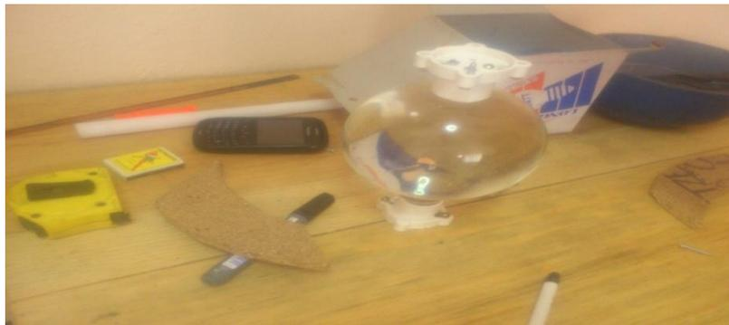
Segundo: Se coloca la bombilla en la flaponera y se procede a elaborar la base y las tiras de insolación que captan los rayos solares.
