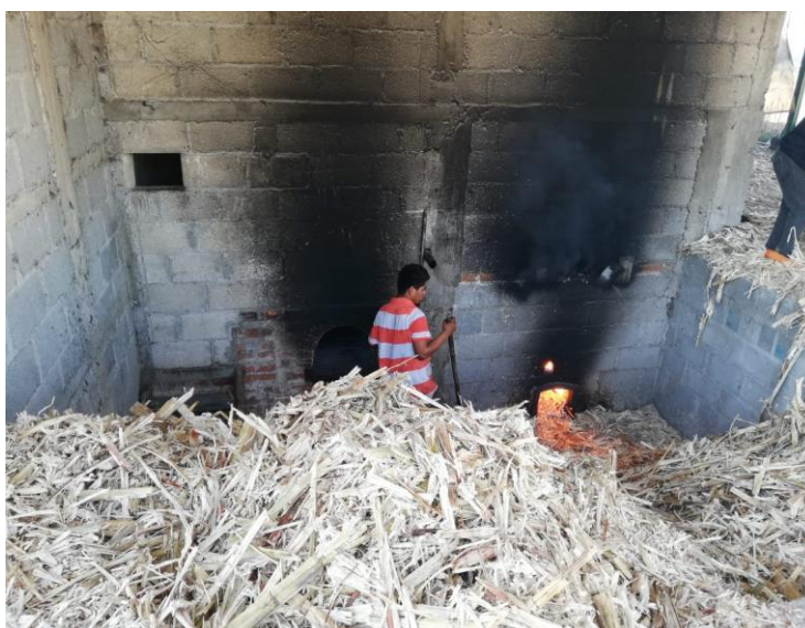
Figura 7. Horno para el funcionamiento de las calderas.
