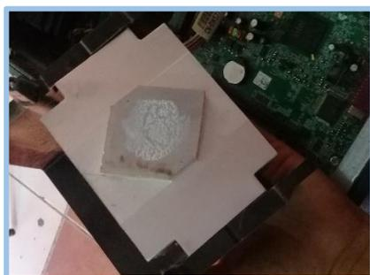
*Figura 46.* Limpieza del disipador térmico de calor aluminio. Elaboración propia (2019).
