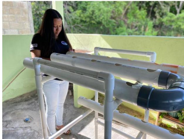
Figura 45. Instalación de los conductos de abastecimiento de agua en la mesa hidropónica. Elaboración propia (2020).
