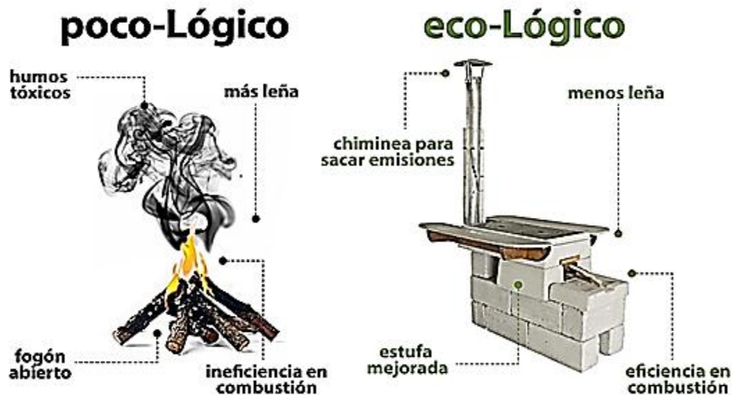
Figura 12. Comparación entre la cocina abierta y la estufa ahorradora de leña.
