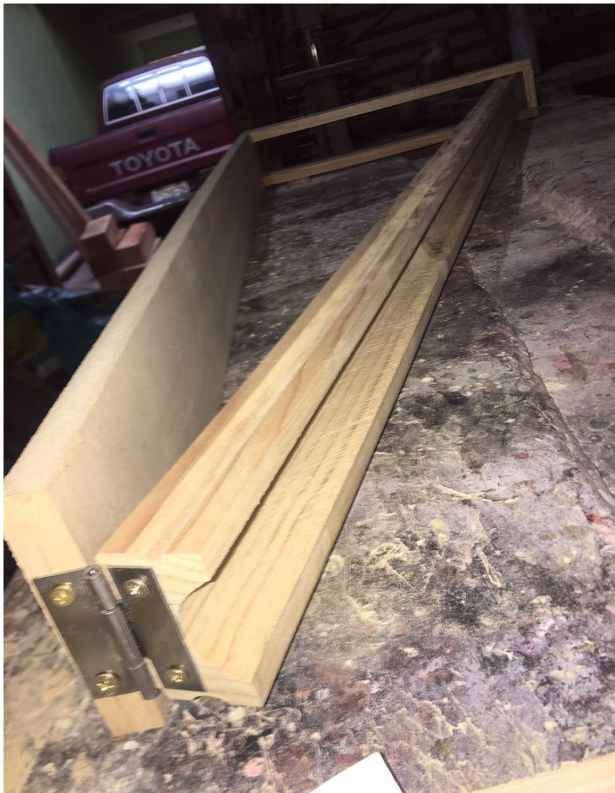
Figura 11 Bisagra colocada en el plano inclinado
