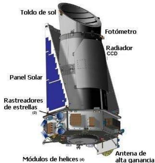
**Figura 2.1.** Ilustración del Telescopio Espacial Kepler donde se muestran algunos de sus componentes. Fuente: Tomada de [7].
