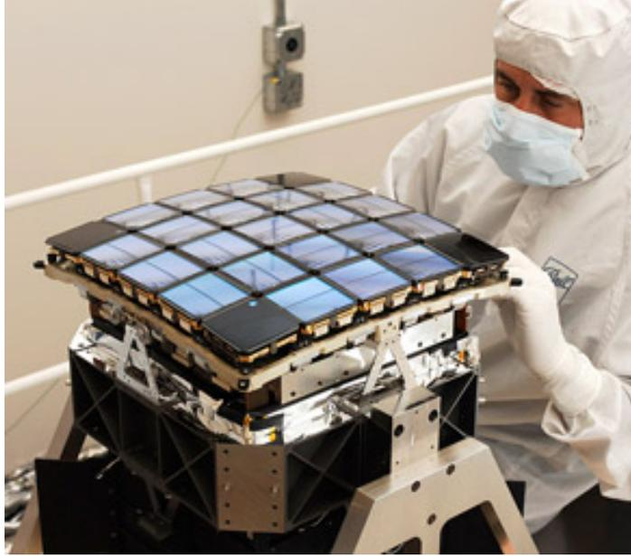
**Figura 2.3.** El plano focal consiste de un arreglo de 42 ccds. Cada una es de 2.8 por 3.0 cm con 1024 x 1100 píxeles. Todo el plano focal contiene 95 Mega píxeles. Fuente: Tomada de [39].
