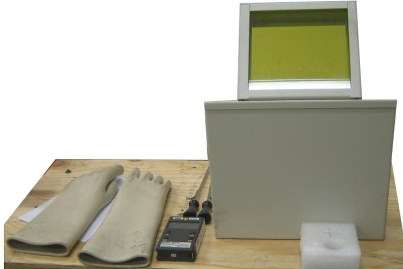
**Figura 2.3.** Equipos varios para la radioprotección. De izquierda a derecha: Guantes plomados, detector de radiación, juego de pinzas especiales para manipular la fuente y mampara con vidrio plomado. Fuente: elaboración propia.
