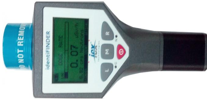
**Figura 2.5.** Espectrómetro de mano, identiFINDER Ultra. Fuente: elaboración propia.
