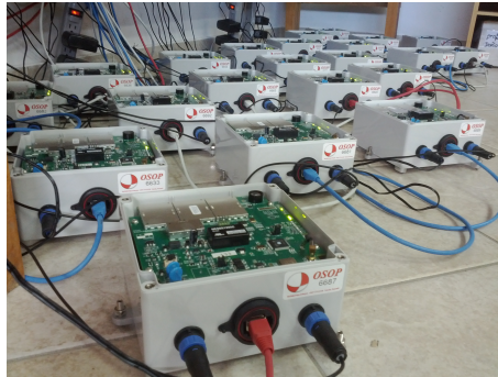
Figura 2.3. Instrumento sísmico de periodo corto, Sixaola4. Foto tomada de la página del fabricante [20]
