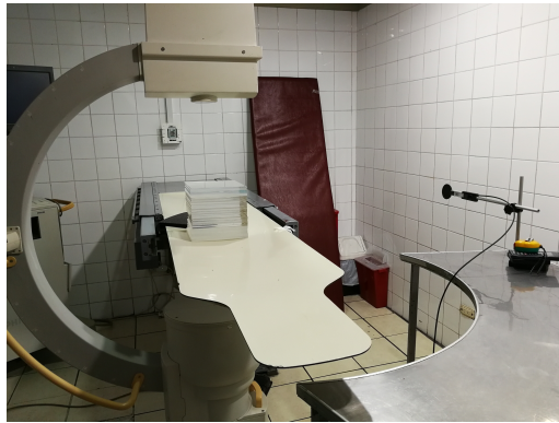
Figura 3.16. Detector RaySafe Xi Survey colocado a un metro hacia la izquierda del fantoma de polimetilmetacrilato en la sala de fluoroscopia de la clínica Intervasc.
