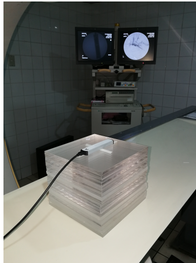
Figura 3.13. Detector RaySafe Xi RF sobre el fantoma de polimetilmetacrilato en la sala de fluoroscopia de la clínica InterVasc.
